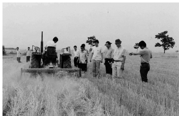
FOTO 3 – De diepwoeler aan het werk in de stoppel van wintertarwe nabij Henan Provincie, China)
