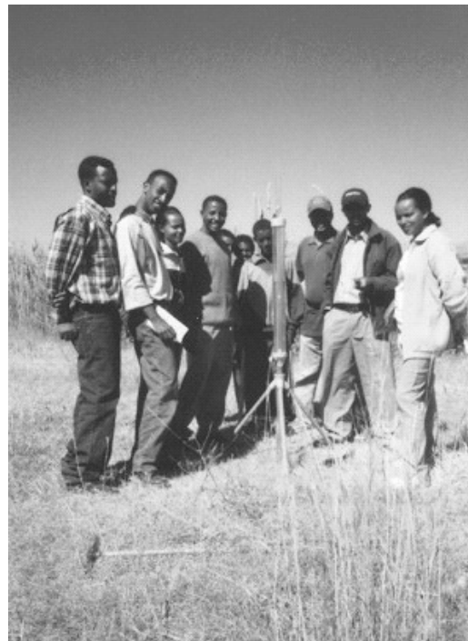
FOTO 6 – Met een 'permeameter' wordt de waterdoorlatendheid (permeabiliteit) van de bodem gemeten op een proefterrein in Mekelle (Ethiopië)
